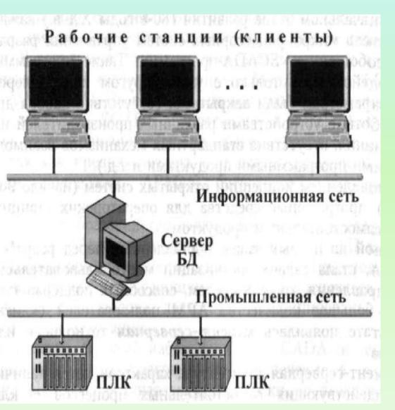
Клиент-серверная архитектура предполагает, что вся информация о технологическом процессе от контроллеров собирается и обрабатывается на сервере ввода/вывода (сервер базы данных), к которому по сети подключаются АРМ клиентов (компьютеры операторов, специалистов).
