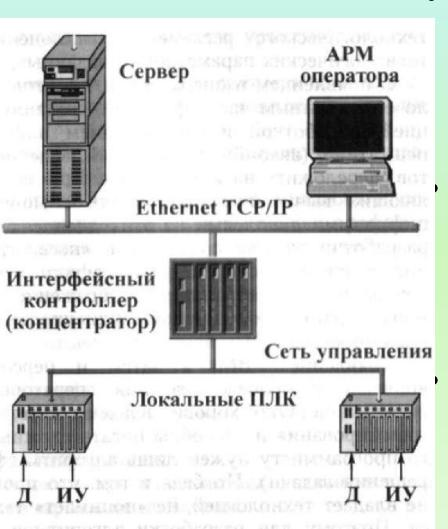
• В типовой архитектуре современной системы управления (АСУТП) явно просматриваются два уровня (рис. 1):
