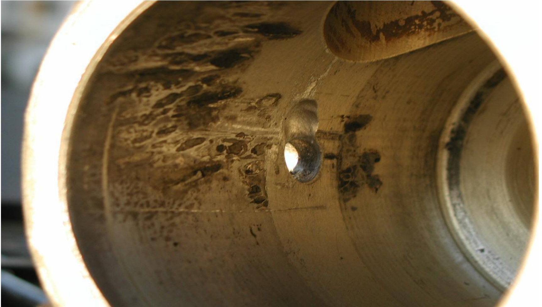
Рис. Задирь (питтинг) внутри головки рулежно-демпфирующего цилиндра (РДЦ) передней ноги самолета Ту-134
