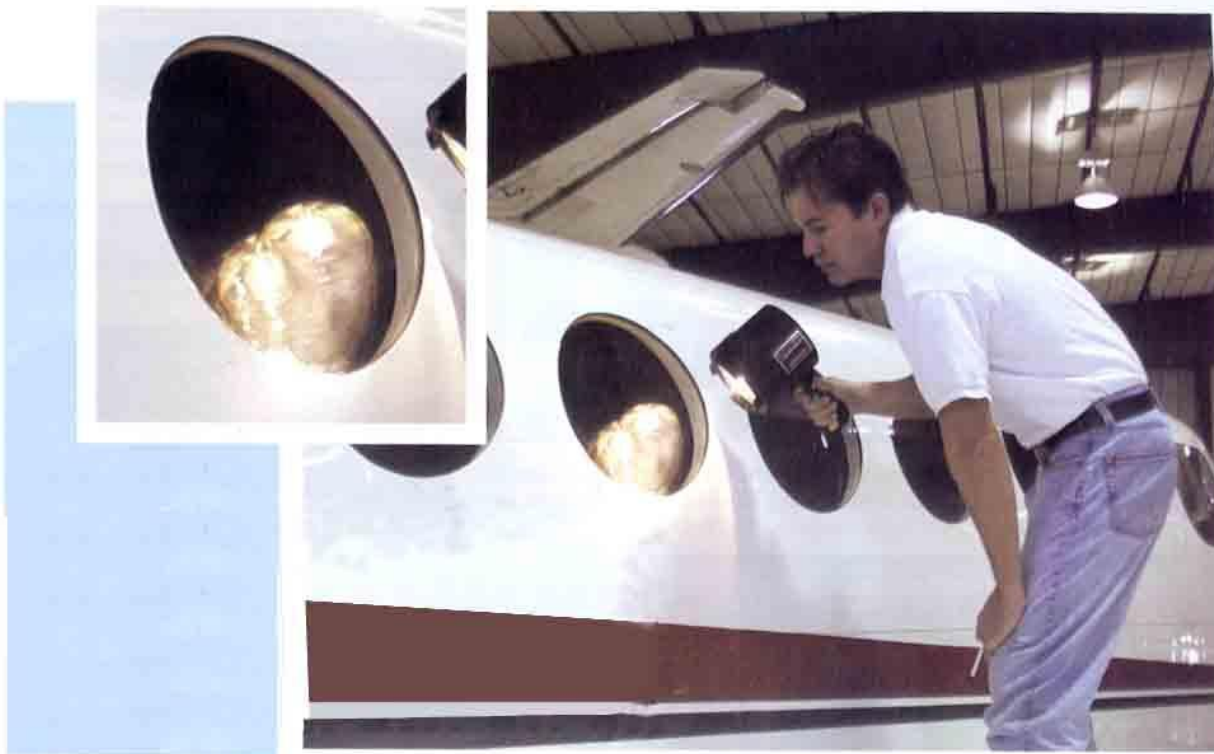
Рис. Направленный под углом к поверхности остекления луч света может помочь выявить всякого рода дефекты – мелкие трещины, расслоения, «серебрение» (появление мелких трещин как следствия влияния сочетания динамических и статических нагрузок, атмосферных перепадов температуры и т. д.)
