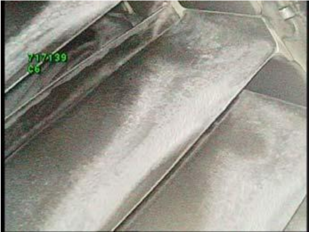
Рис. Солевые отложения на рабочих лопатках компрессора авиационного газотурбинного двигателя
