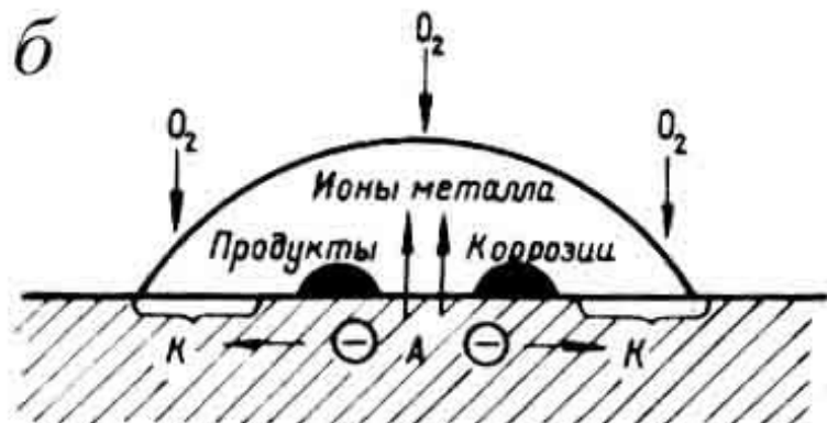
Рис. Схема электрохимической коррозии:
