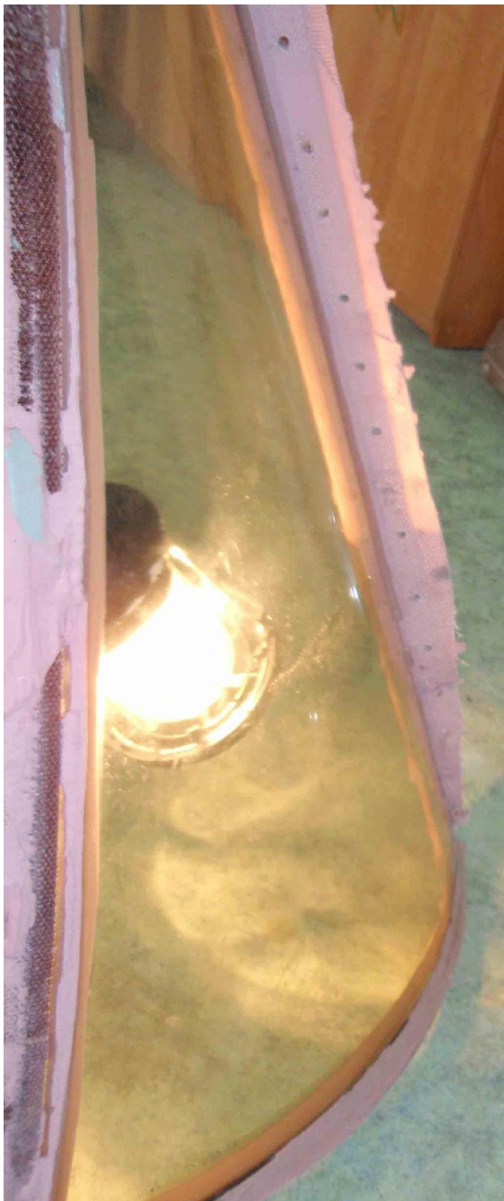
Рис. Образование «серебра» - сетки мельчайших трещин на поверхности оргстекла
