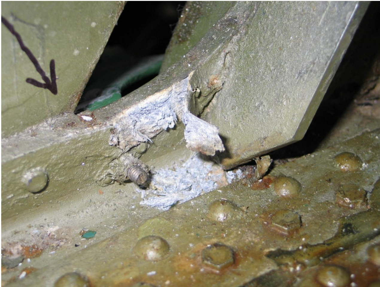
Рис. Расслаивающаяся коррозия стенки верхнего пояса второго лонжерона центроплана шп. № 34 слева (Ту-134А бортовой номер RA 65618 Ф-12 к/н № 12 от 26.01.2005 г.; С.Н.Э.- 30 лет 6 мес., 34647 л.ч., 20237,5 пол., П.П. Р.- 1 год 8 мес., 2419 л.ч., 1011,5 пол.)
