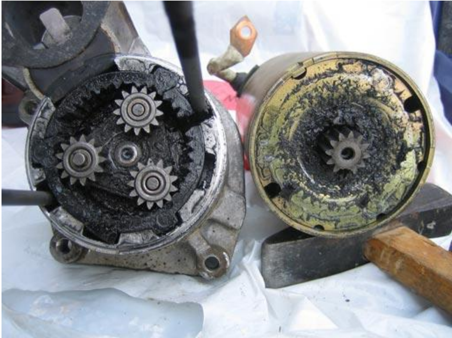
Рис. Изменения состояния уплотнительных прокладок под влиянием старения
