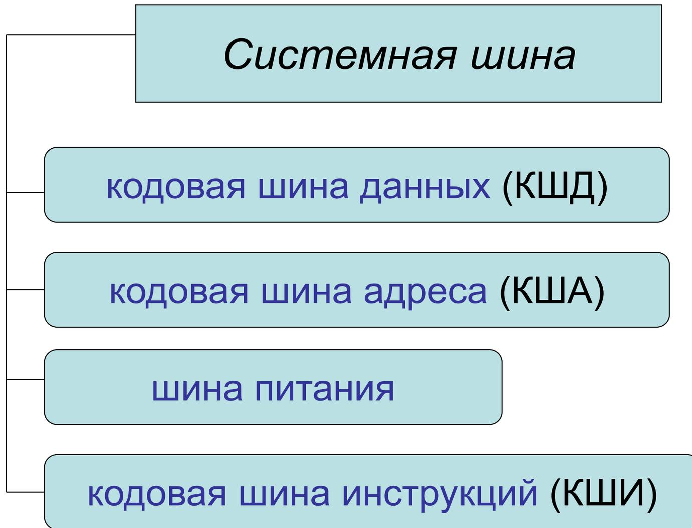
Системная шина – основная интерфейсная система компьютера, обеспечивающая сопряжение и связь всех его устройств между собой. Системная шина включает в себя:
