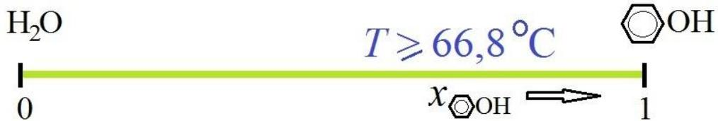
Взаимная растворимость в системе “вода – фенол” при различных *фиксированных* температурах. Давление в системе также фиксировано и равно 1 атм.
