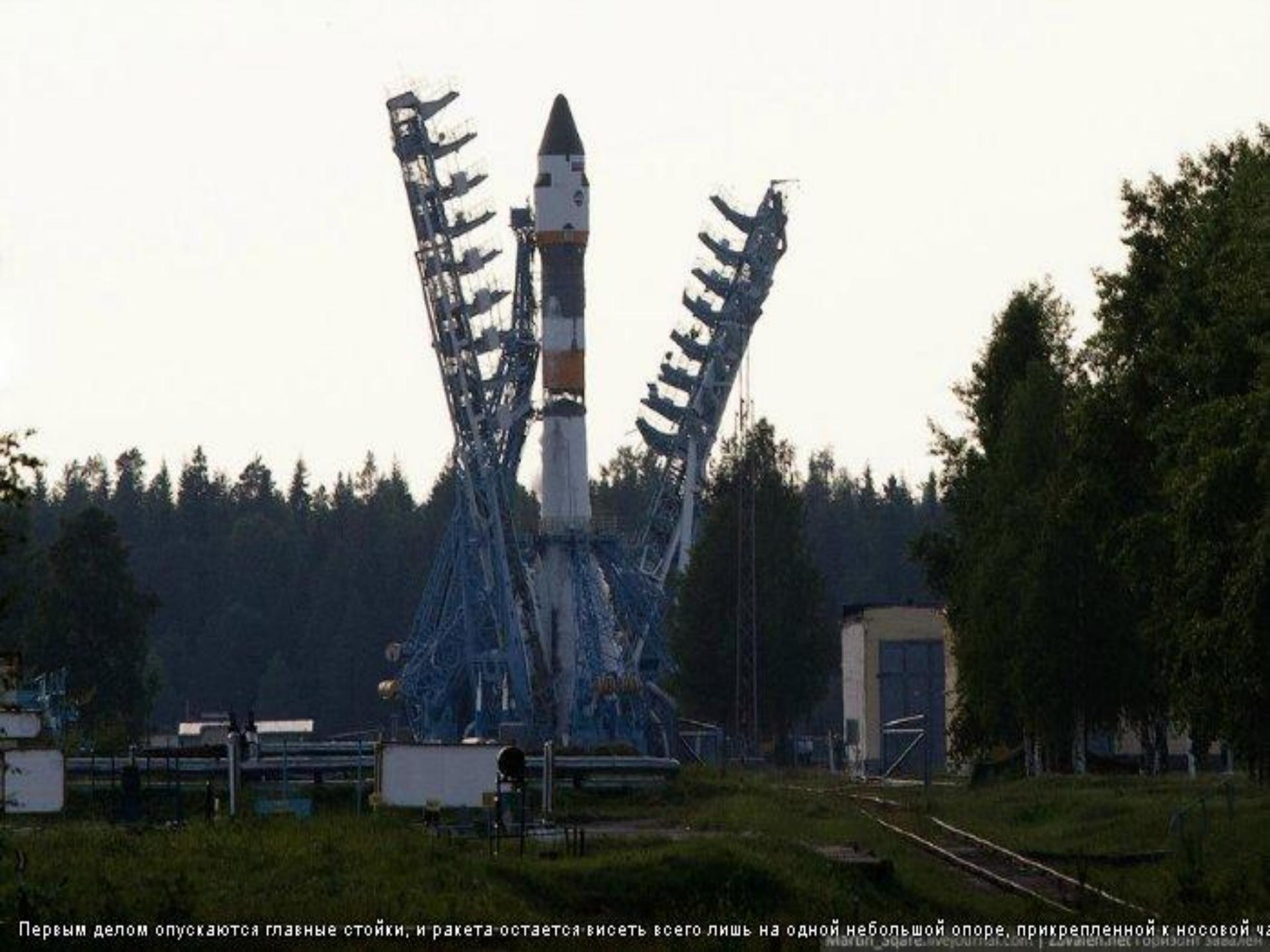
Первым делом опускаются главные стойки, и ракета остается висеть всего лишь на одной небольшой опоре, прикрепленной к носовой ча-
