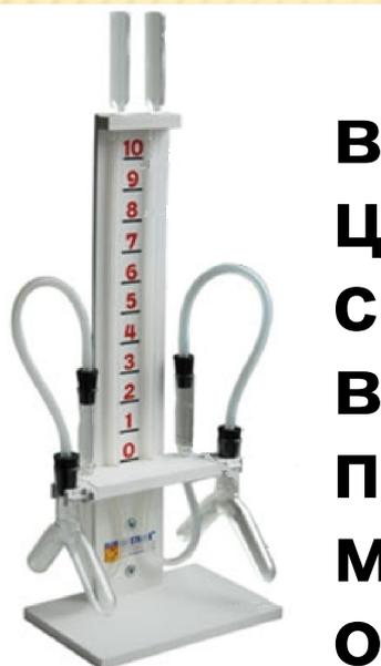
Принцип работы прибора состоит во взаимодействии твердой фазы (гранул цинка) и жидкой (раствора кислоты) в сосудах Ландольта, в результате чего выделяется газ, который по пластиковым трубкам поступает в манометрические трубки, давит на окрашенную жидкость и вызывает ее подъем. О различной скорости химической реакции в двух сосудах Ландольта судят по разности уровней жидкости в манометрических трубках.
