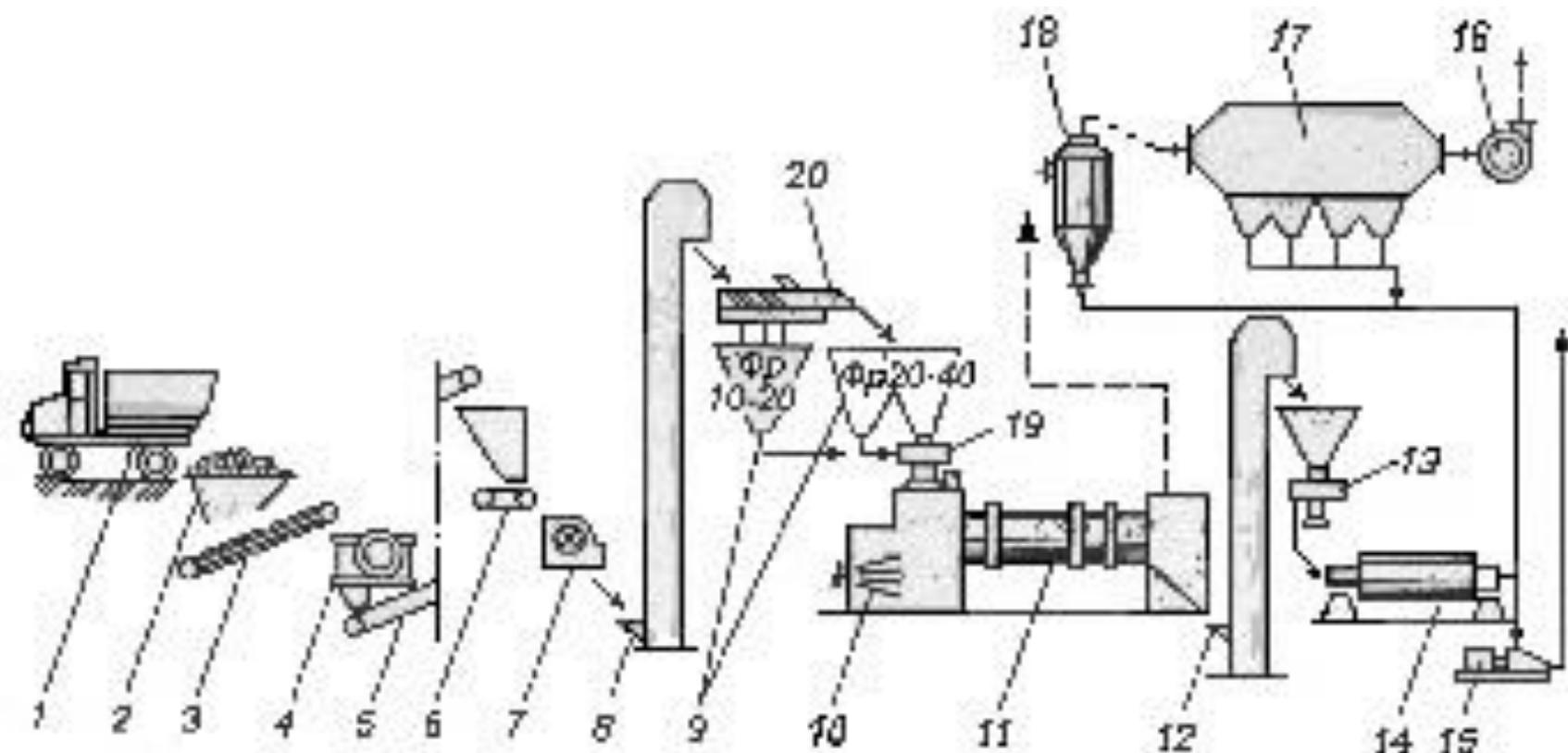
Схема 2. Производство строительного гипсового вяжущего в сушильном барабане:
