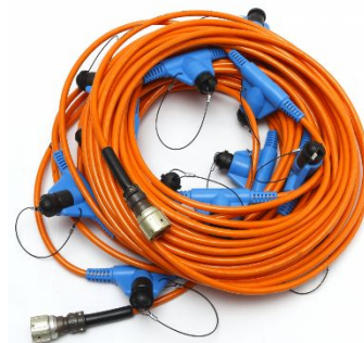
24-х канальная «сейсмическая» коса, шаг 2 м.
