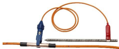
Электроды-шпильки и соединители коса-электрод
