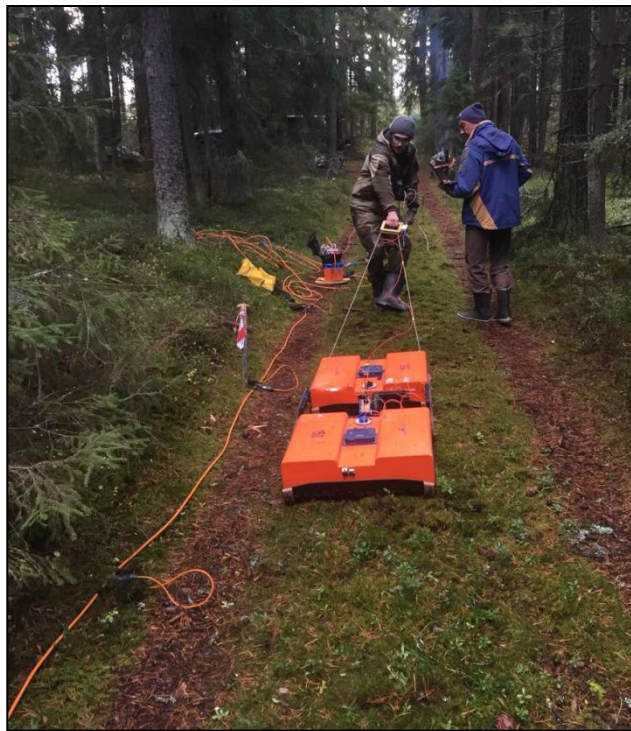
Электроды-шпильки и соединители коса-электрод
