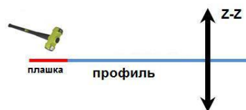
24-х канальная «сейсмическая» коса, шаг 2 м.
