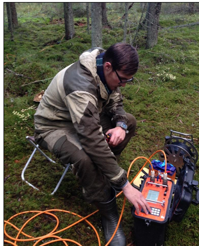
Многоэлектродная электроразведочная станция SKALA-48
