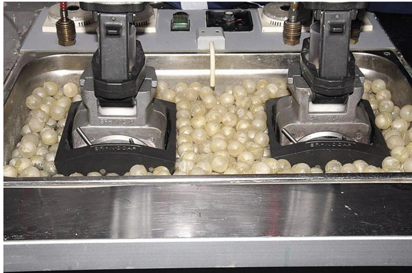
После завершения процесса полимеризации и охлаждения кюветы распаковывают, протезы освобождают от гипса, обработка, шлифовка, полировка протеза.
