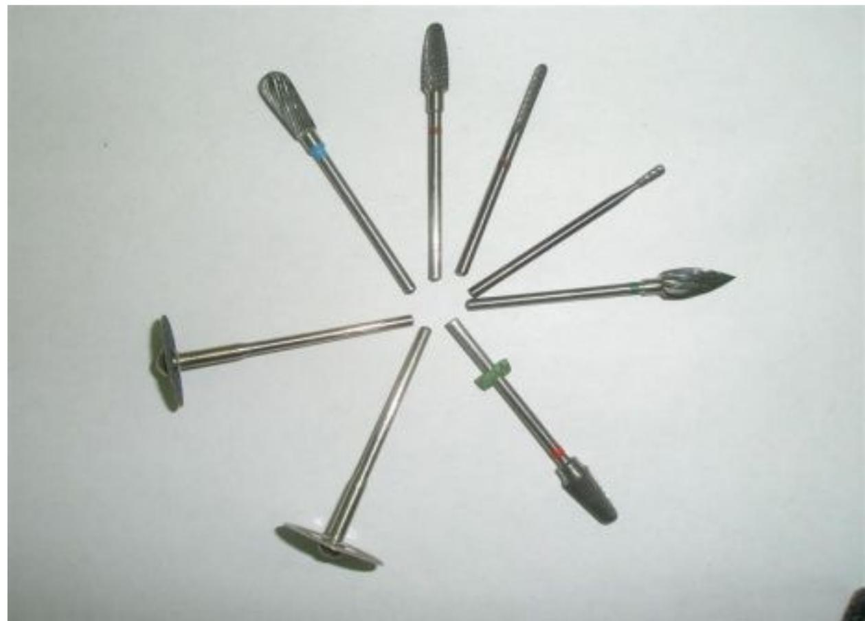
Шлифовку проводят наждачной бумагой, установленной в специальном держателе или специальными шлифовальными головками.
