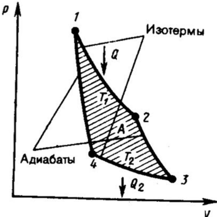
Карно теоретически проанализировал обратимый наиболее экономичный цикл, состоящий из двух изотерм и двух адиабат. Его называют **циклом Карно**.
