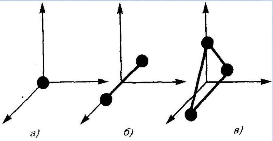
Число степеней свободы - это число независимых переменных (координат), полностью определяющих положение системы в пространстве. В ряде задач молекулу одноатомного газа (рис. а) рассматривают как материальную точку, которой приписывают три степени свободы поступательного движения. При этом энергию вращательного движения можно не учитывать, т.к.
