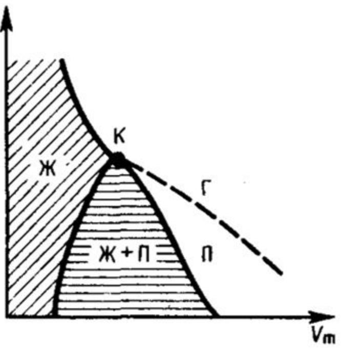
Если через крайние точки горизонтальных участков семейства изотерм провести линию, то получится колоколообразная кривая, ограничивающая область двухфазных состояний вещества. Эта кривая и критическая изотерма делят диаграмму  $p, V_m$  под изотермой на три области: под колоколообразной кривой располагается область двухфазных состояний (жидкость и насыщенный пар), слева от нее находится область жидкого состояния, а справа — область пара.
