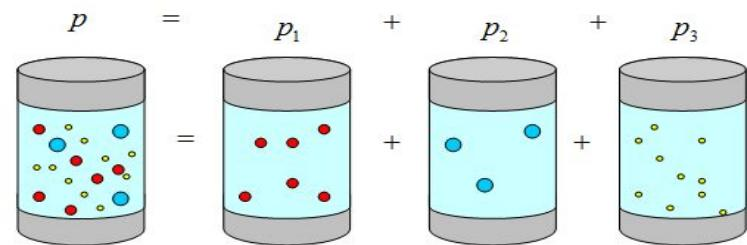
*Давление смеси идеальных газов равно сумме парциальных давлений  $P$ , входящих в неё газов*
