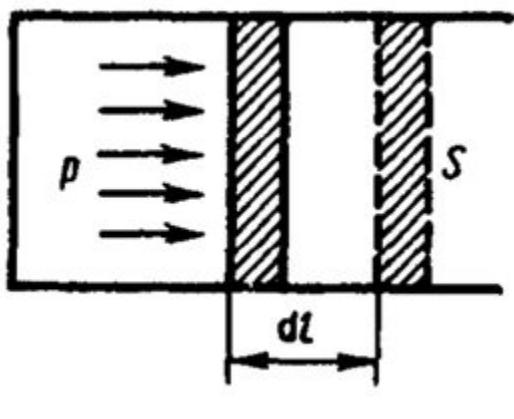
Если газ, расширяясь, передвигает поршень на бесконечно малое расстояние  $dl$ , то производит над ним работу:
