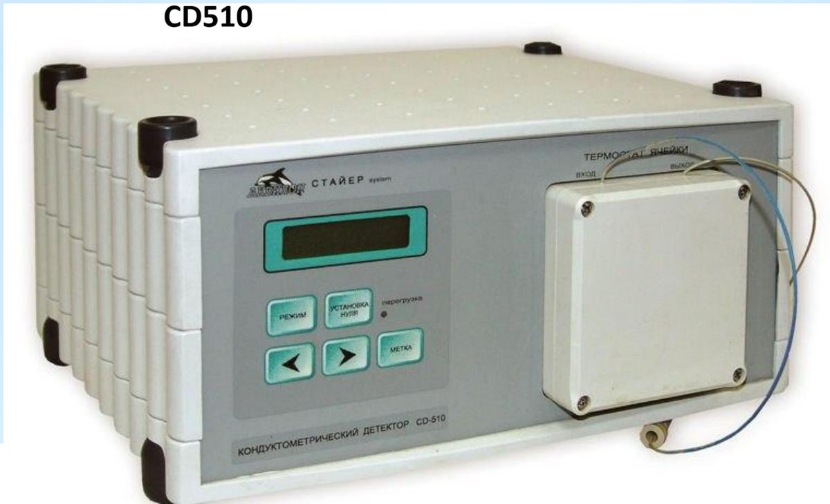
Широкий диапазон электронной компенсации (возможность работы в одно и двухколоночном варианте ионной хроматографии). Высокоточная электронная система термостатирования ячейки. Микропроцессорный контроль. Возможность управления всеми параметрами с собственной клавиатуры, а также внешнее управление и экспорт данных через стандартный RS232 порт. Световая и звуковая индикация перегрузок.
