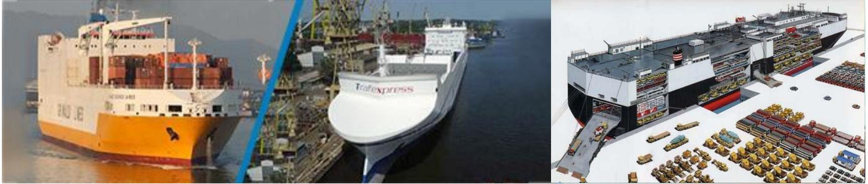
**Ролкер** — морское судно для перевозки грузов, которые загружаются/выгружаются горизонтально.
