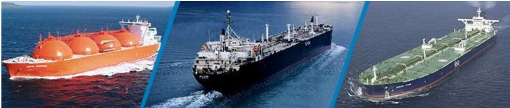
**Танкер** — морское судно, предназначенное для перевозки грузов наливом. К грузам такого типа относятся всевозможные нефтепродукты, сжиженный газ, химические жидкости, цемент, масло, вино. Танкеры не оборудованы погрузочно-разгрузочными средствами, кроме насосов, и имеют только хранилища для перевозки, которые называются танки.
