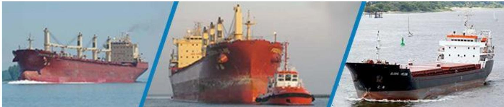
**Балкер** — судно для перевозки насыпных грузов. Как и танкеры, балкеры не оборудованы погрузочными кранами, а имеют в своей конструкции трюмы для насыпных грузов.
