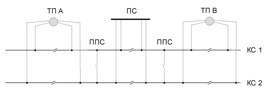
При параллельной схеме питания между контактными подвесками смежных путей 3 и более общих точек (обычно это делается с помощью пунктов параллельного соединения- ППС).
