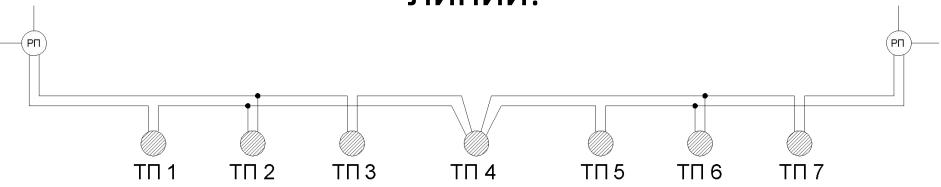
РП- опорные районные подстанции, ТП 4- опорная ТП, ТП 1, 3, 5, 7- транзитные ТП, ТП 2, 6- отпаечные ТП, ТП 1, 2, 3, 5, 6, 7- промежуточные ТП.
