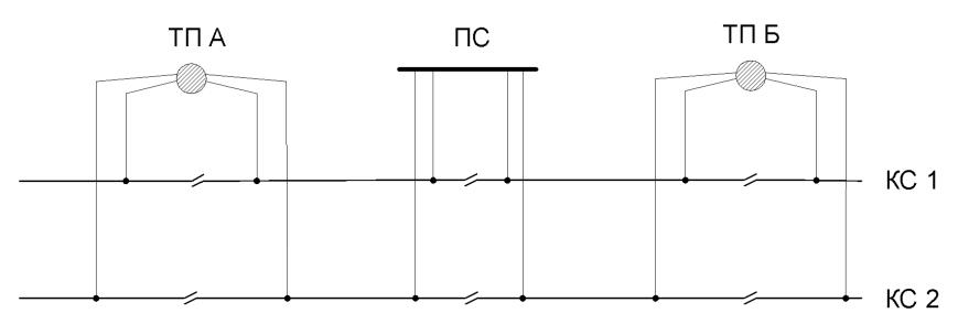
При узловой схеме между контактными подвесками появляется одна общая точка (обычно в середине межподстанционной зоны).
