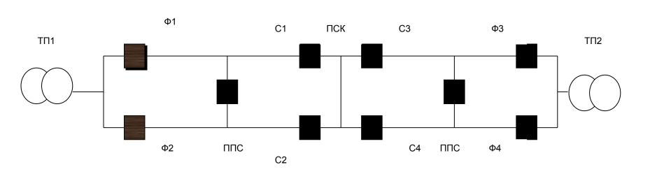
Между ПСК и ТП включёны дополнительно пост параллельного соединения (ППС), который электрически соединяет КС обеих путей
