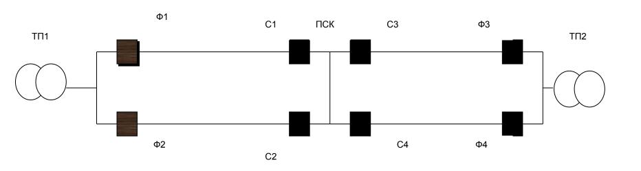
В середине МПЗ включён пост секционирования (ПСК) для электрического соединения КС обеих путей, разделения на секции и защиты КС;
