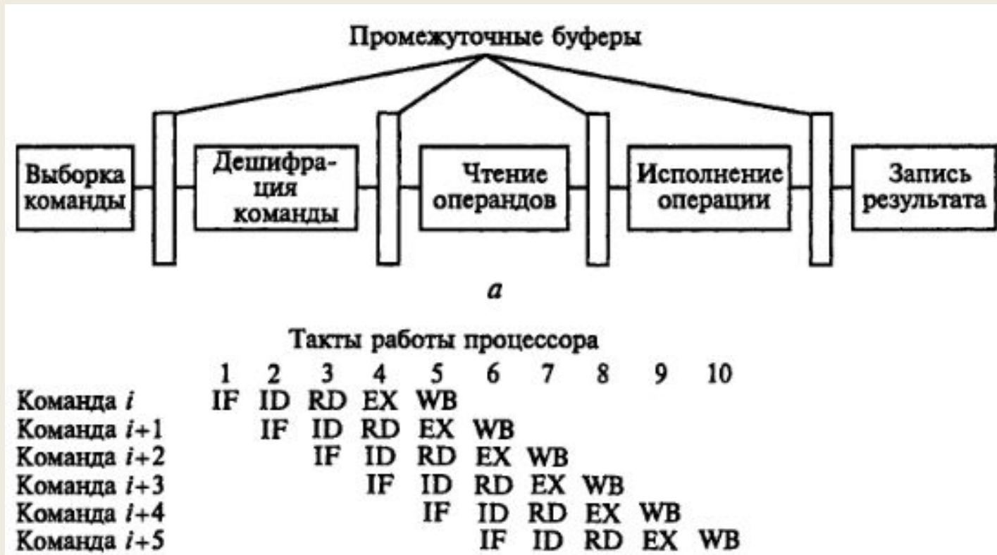
Рис. 8 – Принцип работы конвейера
