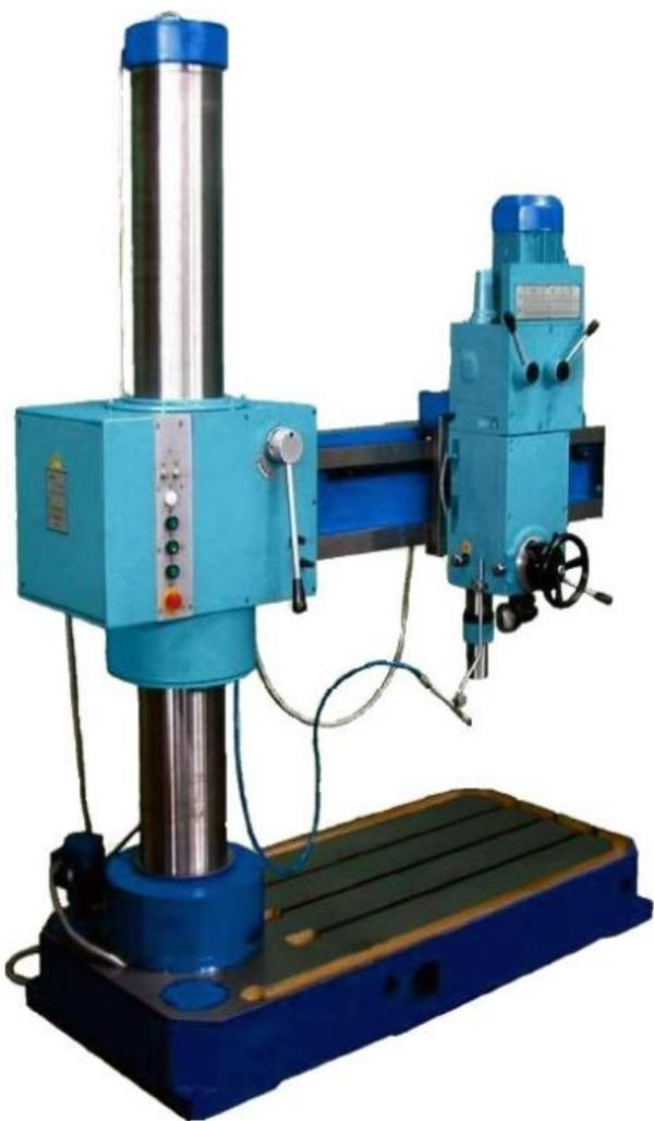
Радиально-сверлильный станок модели 2К522 предназначен для обработки отверстий средних и крупных деталей в единичном, мелкосерийном и серийном производстве.
