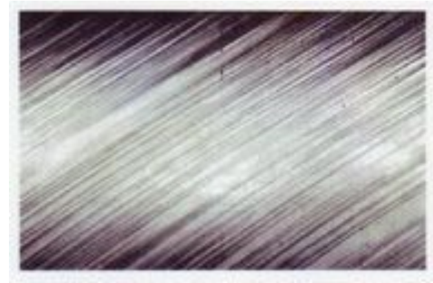
Полосы скольжения в деформированном алюминии
