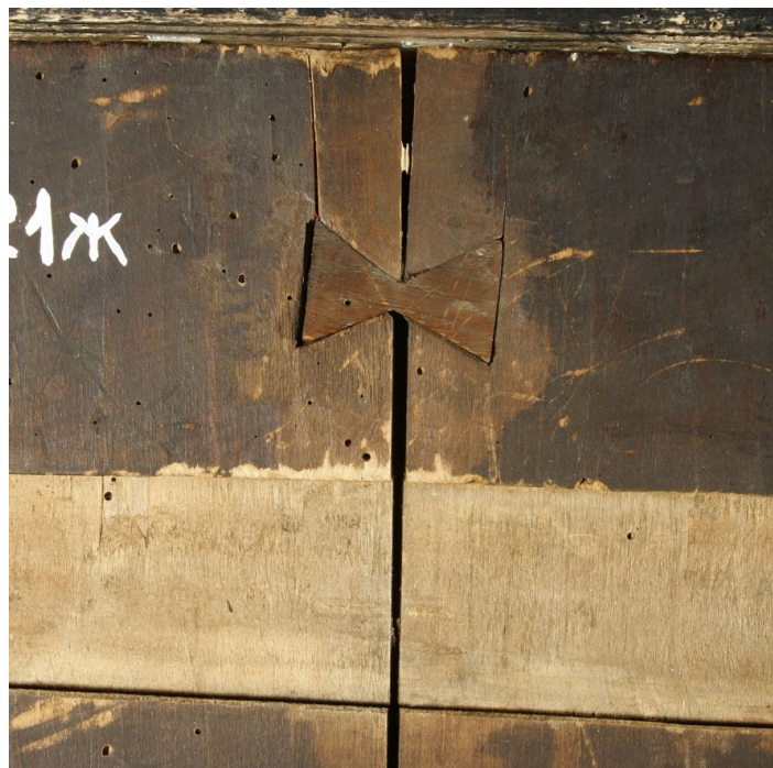
Трещины и утраты фрагментов древесины, утраченные шпонки
