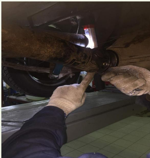
2. Ключами на 17 откручиваем гайки четырех болтов крепления КВ к фланцу ведущей шестерни заднего моста
