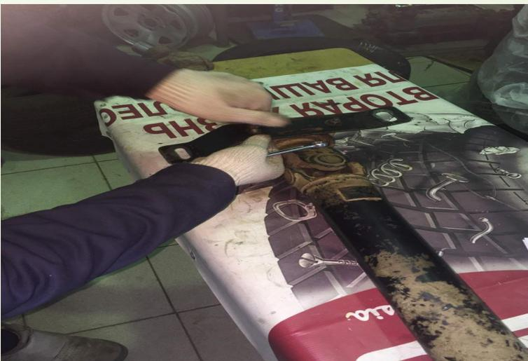
4. Ключом на 13 отворачиваем двух болтов крепления поперечины карданного вала к промежуточной опоре удерживая болты от проворачивания Устанавливаем на автомобиль Волга 31105 КВ в обратной последовательности
