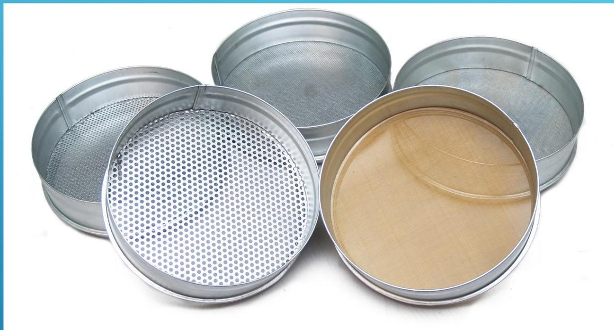
Рисунок 8 – Сита для просеивания
