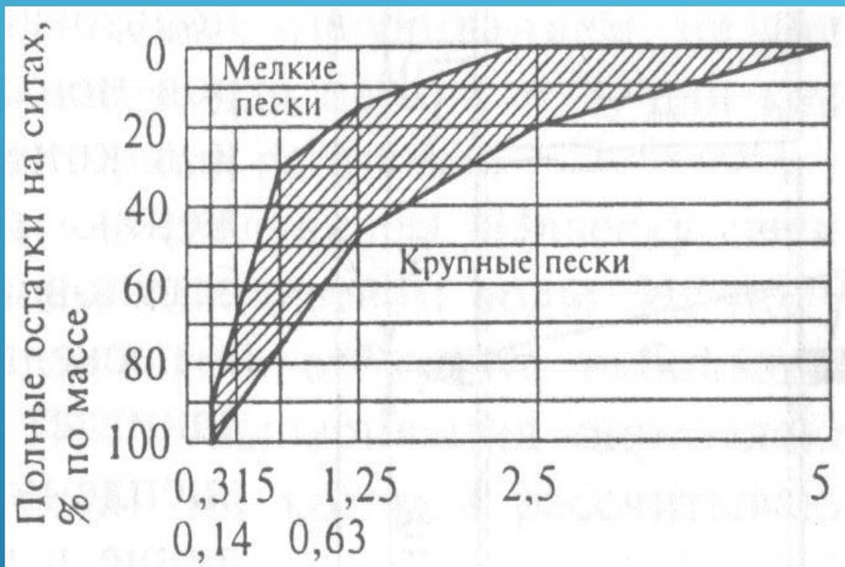
Рисунок 6 - Кривая просеивания песка для бетона (заштрихована область зерновых составов песков, допустимых для использования)
