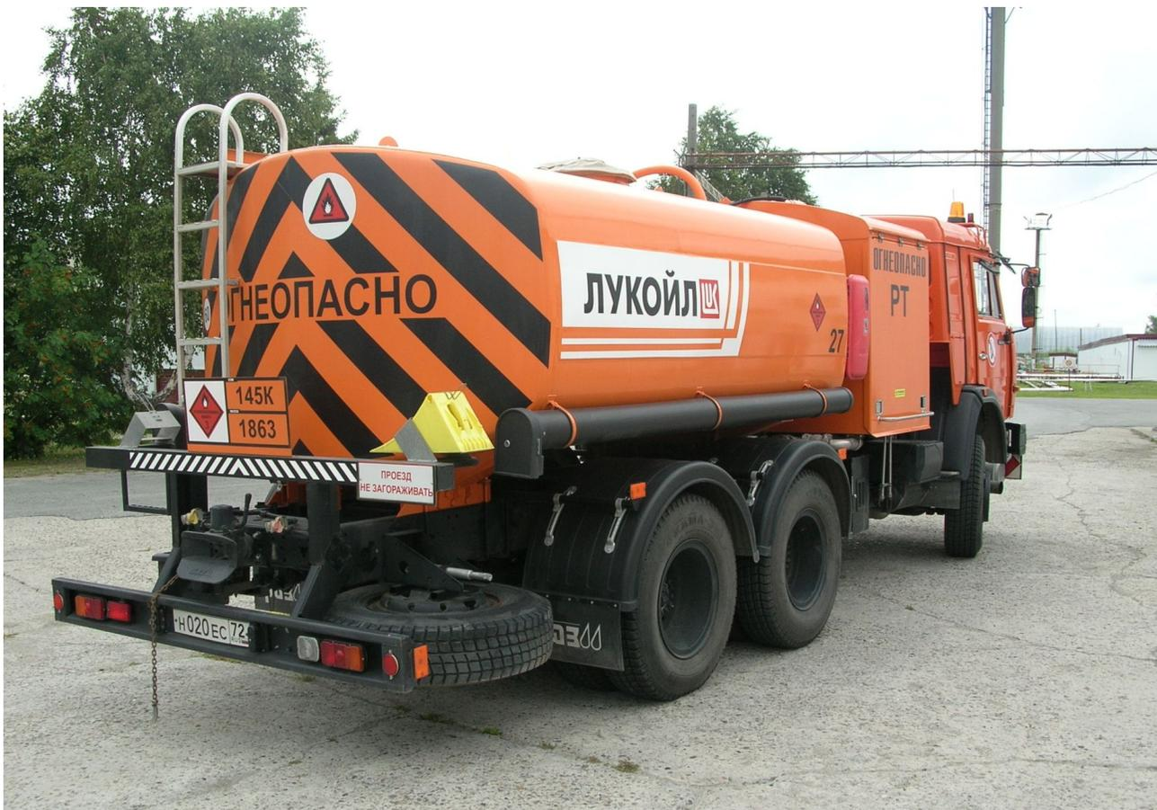
К перевозкам авиаГСМ по дорогам общего пользования, применяются Правила перевозки опасных грузов автомобильным транспортом, в соответствии с которыми цистерны для перевозки легковоспламеняющихся веществ должны быть окрашены в оранжевый цвет.
