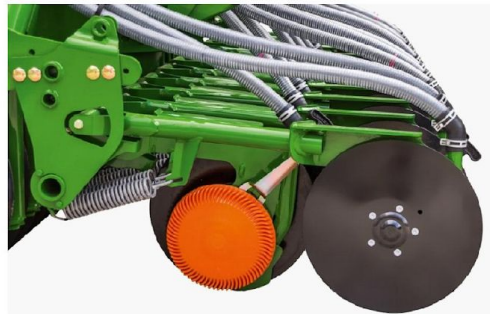
Сошники-уплотнители системы PasTeC сеялки Amazone
