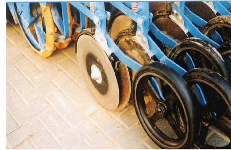
Двухдисковый сошник с прикатывающим роликом сеялки Lemken
