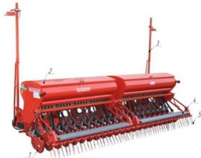
Общий вид сеялки Gaspardo Mega 6: 1 – сошник двухдисковый; 2 – семенной ящик; 3 – маркер; 4 – подножная доска; 5 – загортач
