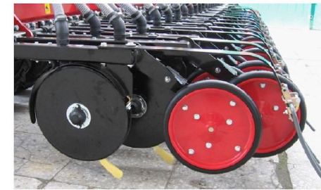
Сошниковые секции системы TurboDisc с копирующе-прикатывающими катками сеялок Horsch
