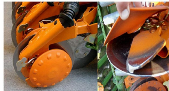
Однодисковый сошник системы Rotek сеялки Amazone
