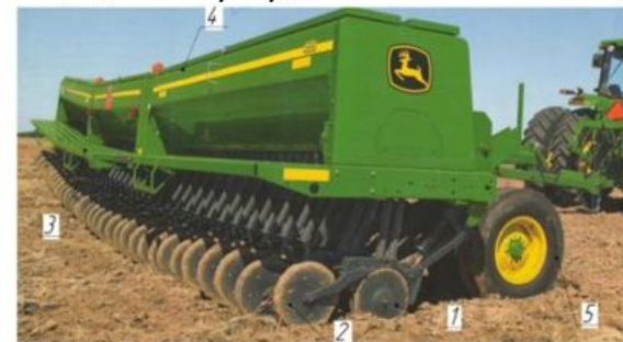
Общий вид сеялки John Deere-455: 1 – сошник двухдисковый; 2 – каток прикатывающий; 3 – подножная доска; 4 – семенной ящик; 5 – колесо опорное
