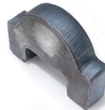
40000 Вт одномодульный: рез углеродистой стали 22 мм
