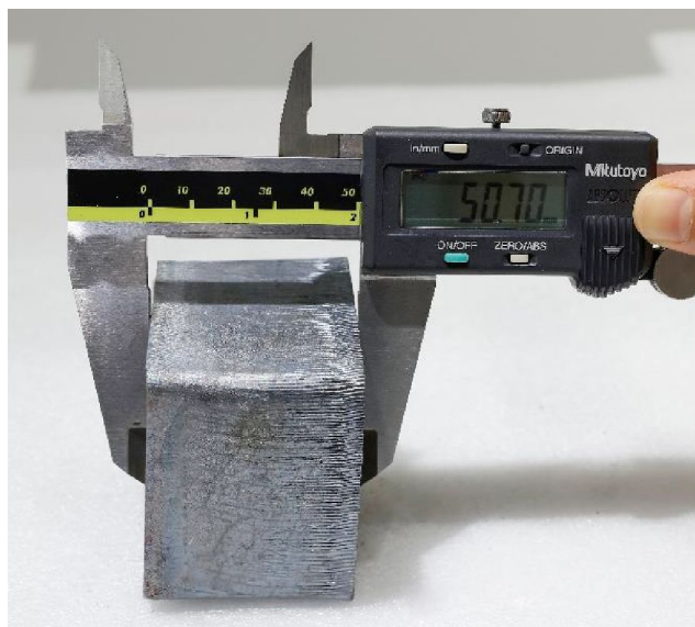
50 мм Ст3 – небольшая «коническая резка»
