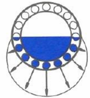
Зона действия нагрузки равна 180° Нулевой зазор
