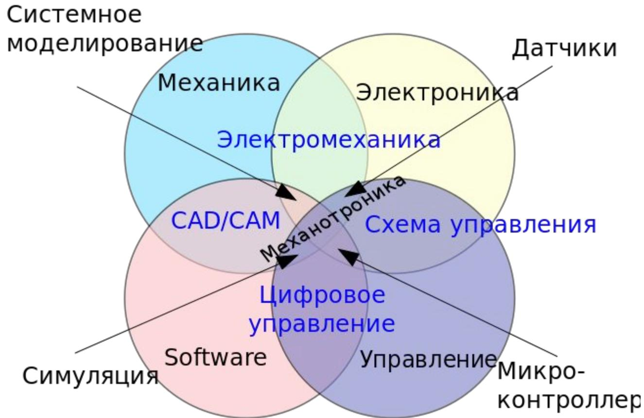
Для **мехатроники** характерно стремление к полной интеграции механических узлов, электрических машин, силовой электроники, программируемых контроллеров.
