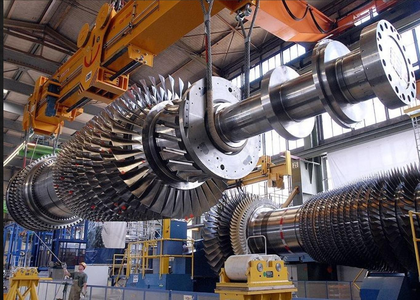
Газовая турбина— это лопаточная машина, в ступенях которой энергия сжатого и/или нагретого газа преобразуется в механическую работу на валу.
