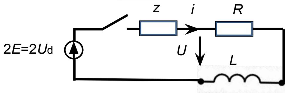
$$\begin{cases} i = i_d + i_r \\ u = u_d + u_r \\ u_d = z i_d \\ u_r = -z i_r \end{cases} \quad \begin{cases} u_d = E \\ i_d = E / z \end{cases} \quad 2u_d = u + z i$$
