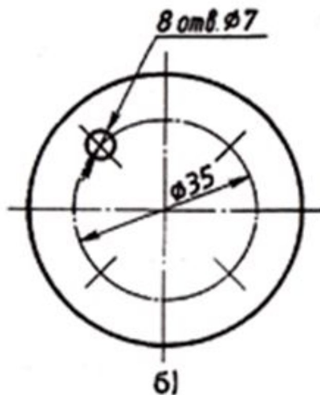
Рис. 48. Нанесение размеров одинаковых отверстий, равномерно расположенных по окружности
