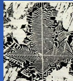
Скелетная эвтектика \gamma(\text{Fe}) + (\text{W}, \text{Fe})_6\text{C}
