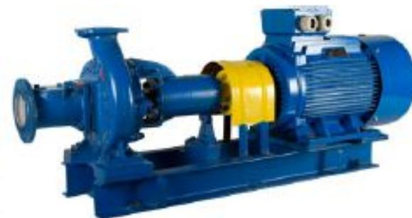
Насосы типа К предназначены для перекачивания воды производственно-технического назначения с рН от 6 до 9 (кроме морской) и других жидкостей, сходных с водой по плотности, вязкости и химической активности в системах водоснабжения, отопления, циркуляции. Размер твердых включений до 0,2 мм с объемной концентрацией не более 0,1%.
