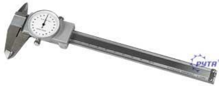
Штангенциркуль с круговой цифровой шкалой. Предел измерения 0-150 мм, точность измерения 0,1 мм
