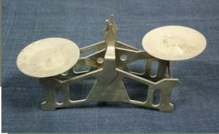
Весы ручные аптечные. Эти весы, предназначенные для взвешивания сыпучих материалов (ВСМ) - измерения массы преимущественно порошкообразных лекарственных веществ и их смесей. ВСМ изготовляют четырех типоразмеров: ВСМ-1,
