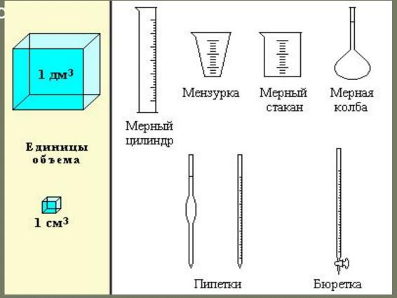
Следует помнить, что объем вытекающей из прибора жидкости сильно зависит от способа вытекания. Поэтому никогда не следует стремиться выгнать остатки жидкости из пипетки выдуванием, а после полного стекания жидкости выждать 2—3 с. Отмеривание жидкостей по разности делений не допускается
