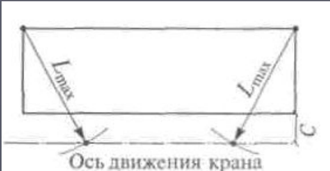
Схемы для расчёта продольной привязки у здания и выемки
