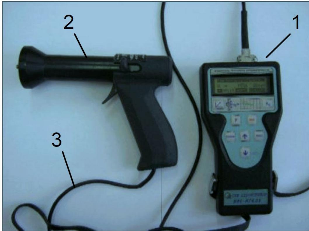
**Рис. 1.5.** Измеритель прочности бетона ИПС-МГ4.01:
