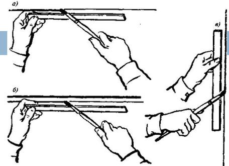
Филенка выполняется с использованием тех составов, которыми окрашена основная поверхность. Окрасочный состав для филенки должен быть более жидким, но с большим количеством вяжущего.
