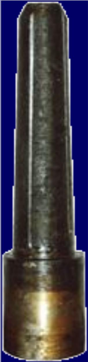
Это ловильный инструмент, предназначенный для ловли труб захватом их за внутреннюю поверхность.
