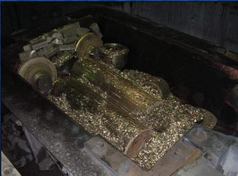
Внешний вид тигля гарнисажной печи с загруженной шихтой
