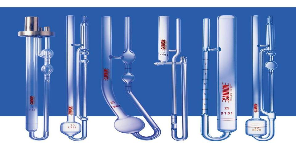
В начале и конце нижней емкости расположены метки M1 и M2, по которым определяют время перетекания жидкости. Например, время  $\Delta \tau$  = 10 с, а постоянная прибора C = 0,1 мм2/c2. Кинематическую вязкость в сСт (мм2/c) находят по формуле
