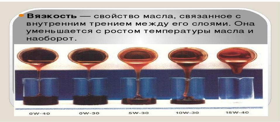
*Кинематическая вязкость.*  $v = \mu/\Box = m2/c$ , для воды  $1\cdot 10$ -6 м2/с. Вязкость измеряют в стоксах или сантистоксах (1CT = 1cm2/c; 1cCT = 1mm2/c)
