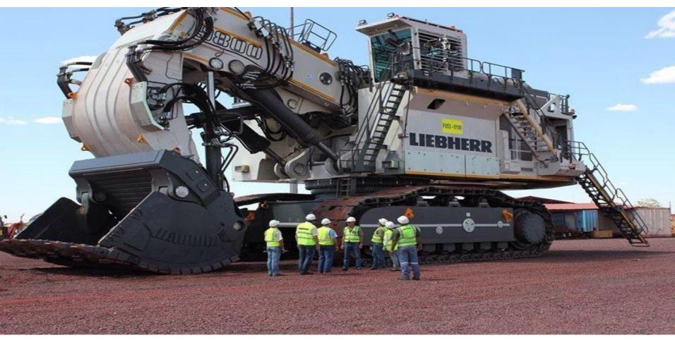
Величину давления  $\Delta P$  ограничивают при помощи перепускных или предохранительных клапанов. Оптимальная величина  $\Delta P$  выбирается с учётом назначения конструкции исполнительного механизма, например гидроцилиндра для привода в действие ковша экскаватора. В гидравлических системах давление масла не превышает 30 МПа
