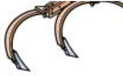
Долотообразные нарральники рыхлительных лап имеют две режущие кромки с углом раствора  $60...70^\circ$ . Нарральники закреплены на пружинных или жестких стойках. Двусторонние нарральники после износа одного конца поворачивают на  $180^\circ$ .
