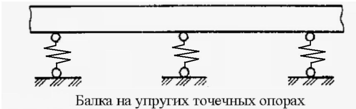
Первая схема имеет достаточно простое аналитическое решение, удобна, дает простые расчетные формулы, достаточно точна, поэтому в настоящее время пользуются ею.
