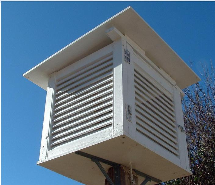
Будка, в которой на метеорологической станции устанавливают психрометр, гигрометр, максимальный и минимальный термометры. М. б. представляет собой деревянную будку белого цвета с жалюзи (*рис.*) для свободного доступа воздуха к приборам. Она защищает приборы от дождя, снега, прямого действия лучей солнца, излучения почвы. Устанавливается на стойках так, чтобы резервуары
