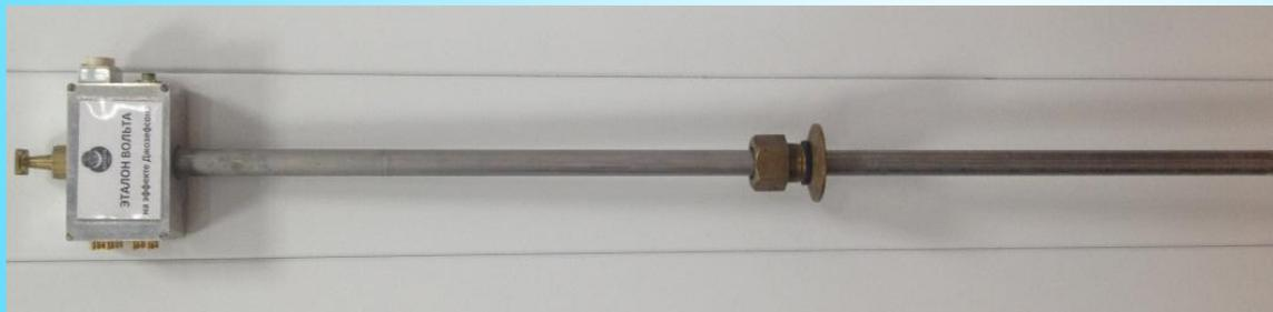
❖ Зонд (криогенный) для обеспечения рабочих условий работы джозефсоновской микросхемы
