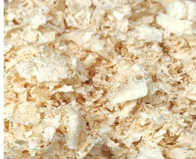
Вид стружки от четырехсторонних станков
