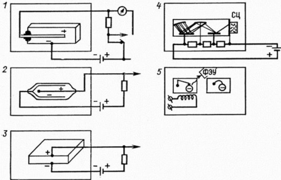
Рис. 1. Схемы чувствительных элементов (детекторов) для приборов, используемых при ядерно-геофизических наблюдениях: 1 – ионизационная камера; 2 – счетчик Гейгера–Мюллера; 3 – полупроводниковый кристалл; 4 – сцинтилляционный счетчик; 5 – термоллюминесцентный кристалл; СЦ – сцинтиллятор; ФЭУ – фотозлектронный умножитель
