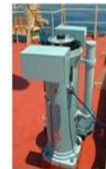
Рис. 3.1. Главный магнитный компас
