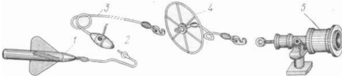
Рис. Лаг ЛЗМ вертушка 1, соединительная груша 2, лаглинь 3, маховик 4 и механический счетчик 5.
