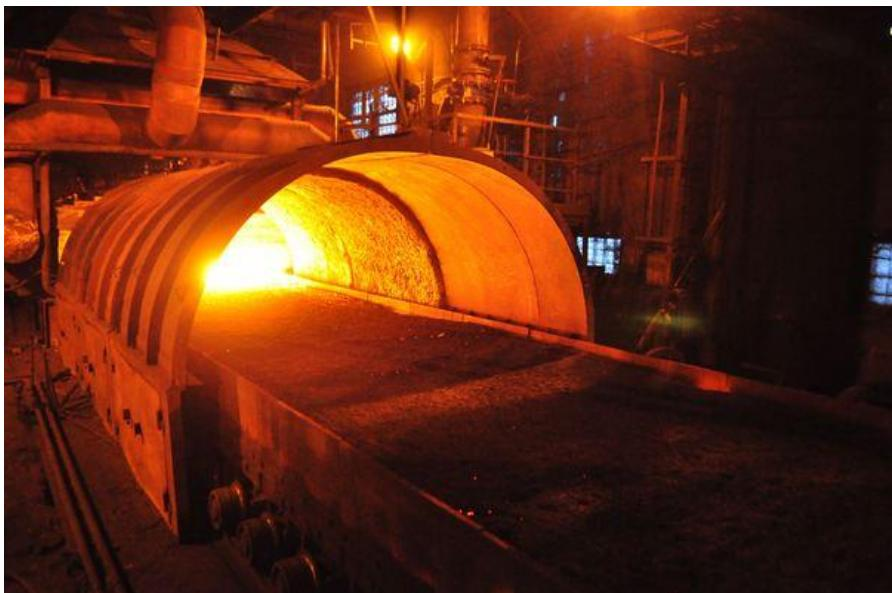
**Процесс получения** аглопоритового гравия заключается в спекании шихты на агломерационных решетках в условии высоких температур в течение короткого времени.
