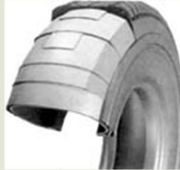
Каркас для автопокрышки из кордной ткани
