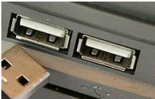
**USB разъем.** Цифровой разъем, для подключения флеш-накопителя, фотоаппарата, видеокамеры, Wi-Fi адаптора, клавиатуры и т.д.
