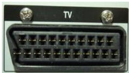
**SCART** - это европейский стандарт для подключения различных устройств. Передача аудио- и видеосигналов. Просмотр HD-видео. (устарел, именно ему на смену пришел HDMI)
