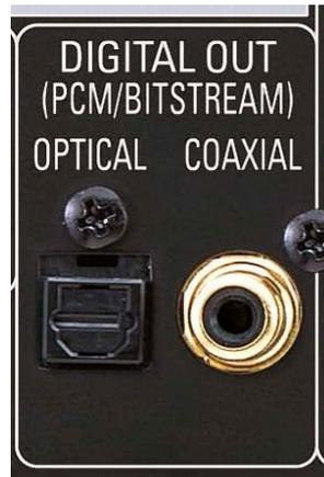
**SPDIF (оптический и коаксиальный)**- максимальный поток составляет чуть больше 1,5 Мбит/с, необходимые для передачи звука в простом формате DTS 5.1, Не преобразовывает цифровой звук в аналоговый- нет потери качества. Не поддерживает Dolby TrueHD и DTS-HD
