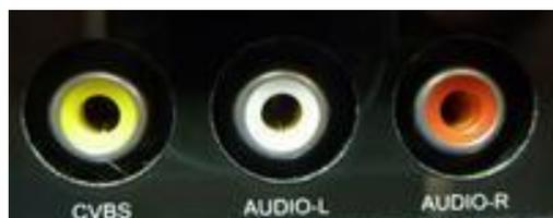
простой композитный вход
