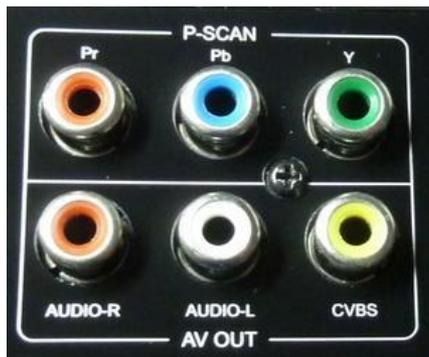
**Компонентный вход.** Все составляющие (компоненты) видеосигнала – один сигнал яркости и два цветowych – передаются по разным проводам. Эти сигналы обозначаются так: Y Pb Pr. (лучше RCA, но хуже
