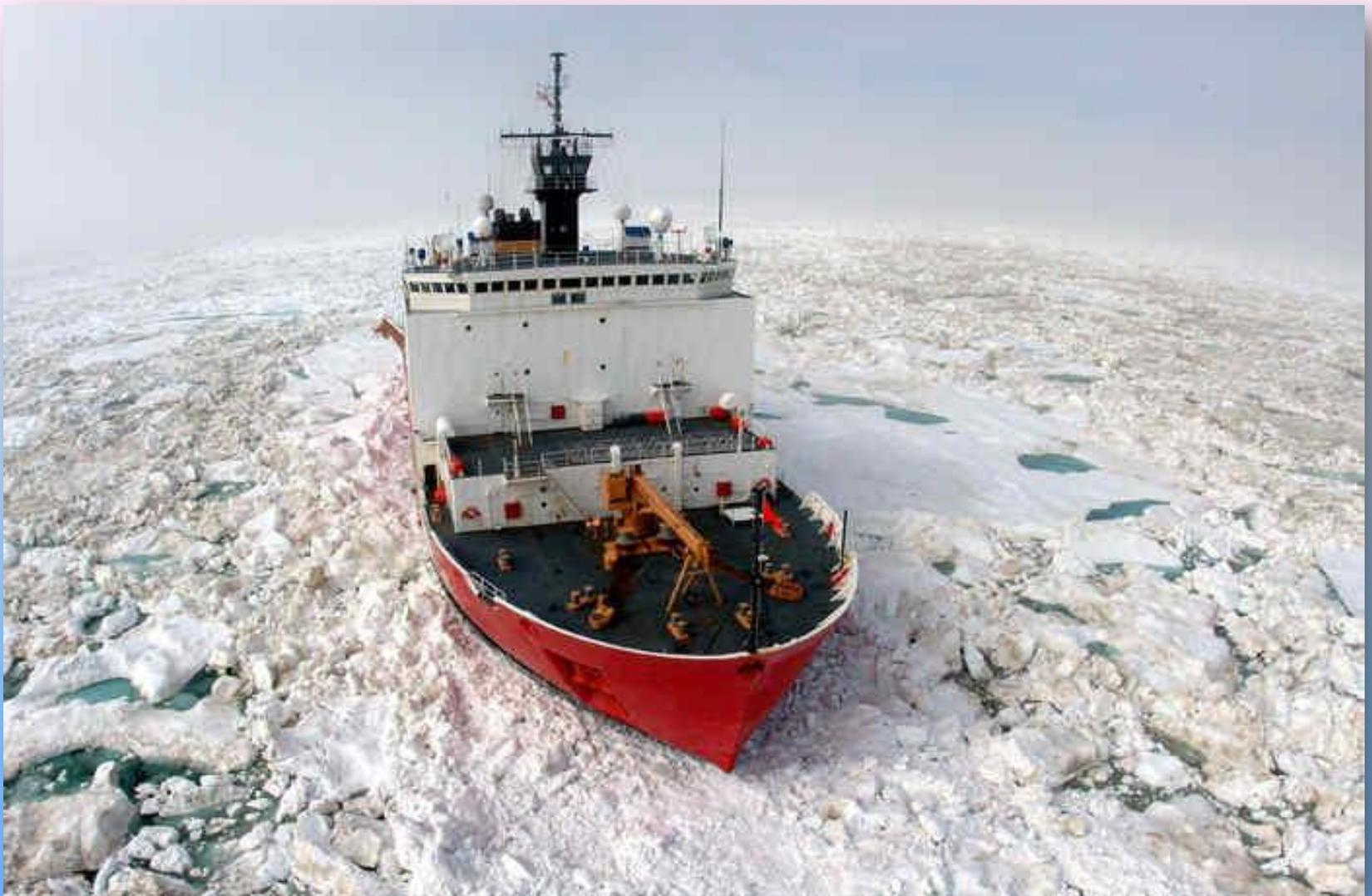
**Корабль-ледокол устроен так, чтобы прокладывать во льдах путь по воде другим кораблям. Нос у него, как огромный утюг, вонзается в льдину, а потом и весь корабль на неё своей тяжестью наваливается. Лёд**
