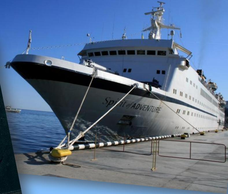
**Корабль имеет стальные тросы, при помощи которых он швартуется к берегу, и якорь, который опускают на цепи на дно моря, если нужно удержать корабль на одном месте.**
