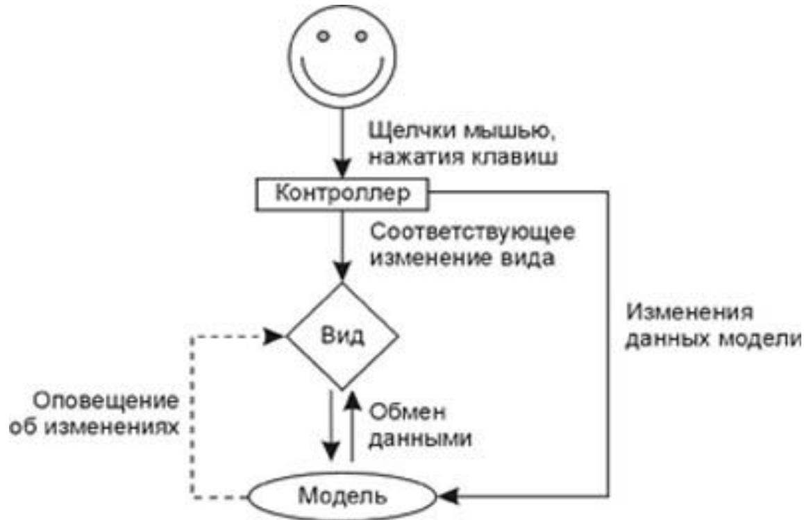
Тесная связь между контроллером и моделью и контроллером и видом. Представление (вид) сопоставлено с единственным Контроллером и каждый Контроллер с единственным Представлением. Представление и Контроллер имеют прямую ссылку на
