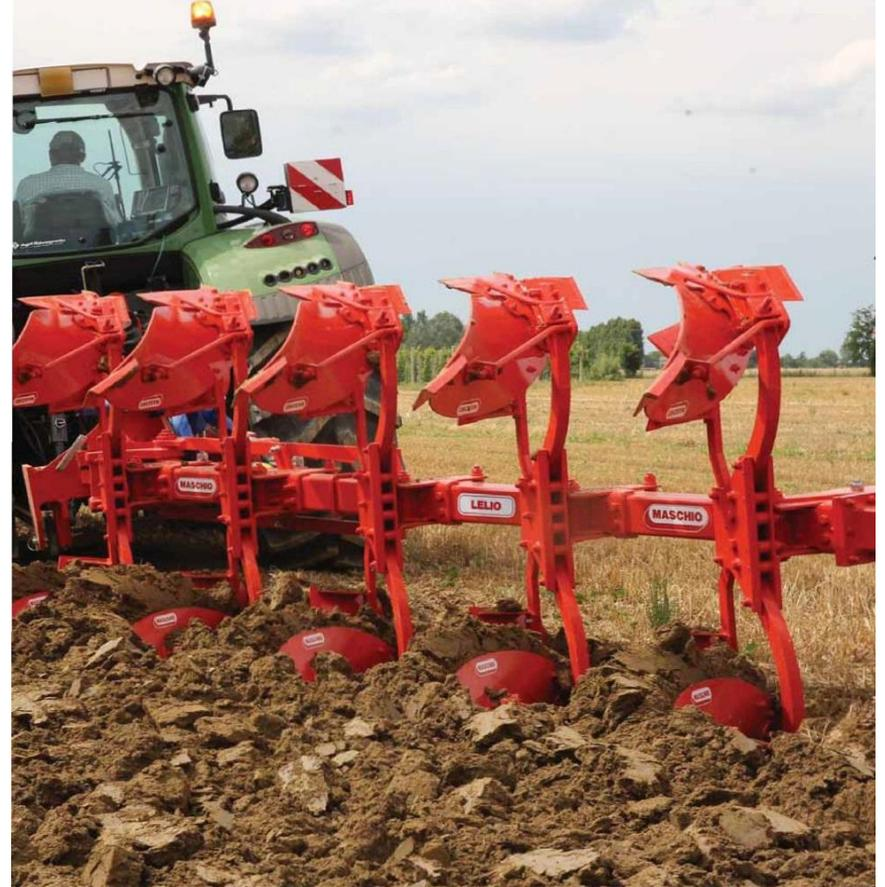
Рама специальной конструкции с большим сечением **до 180 мм.**, расстановкой корпусов **до 120 см.**, и клиренсом под рамой (расстояние между рамой и почвой) **до 100 см.** позволяет быть востребованной для работы на самых тяжелых почвах.
